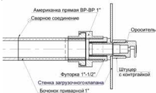
Рисунок 3 – Монтаж оросителя.
