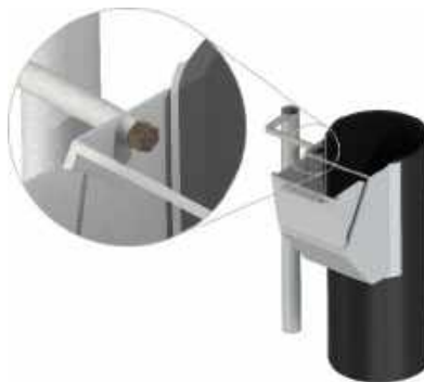
Рисунок 2 – Расположение оросителя внутри загрузочного клапана.
