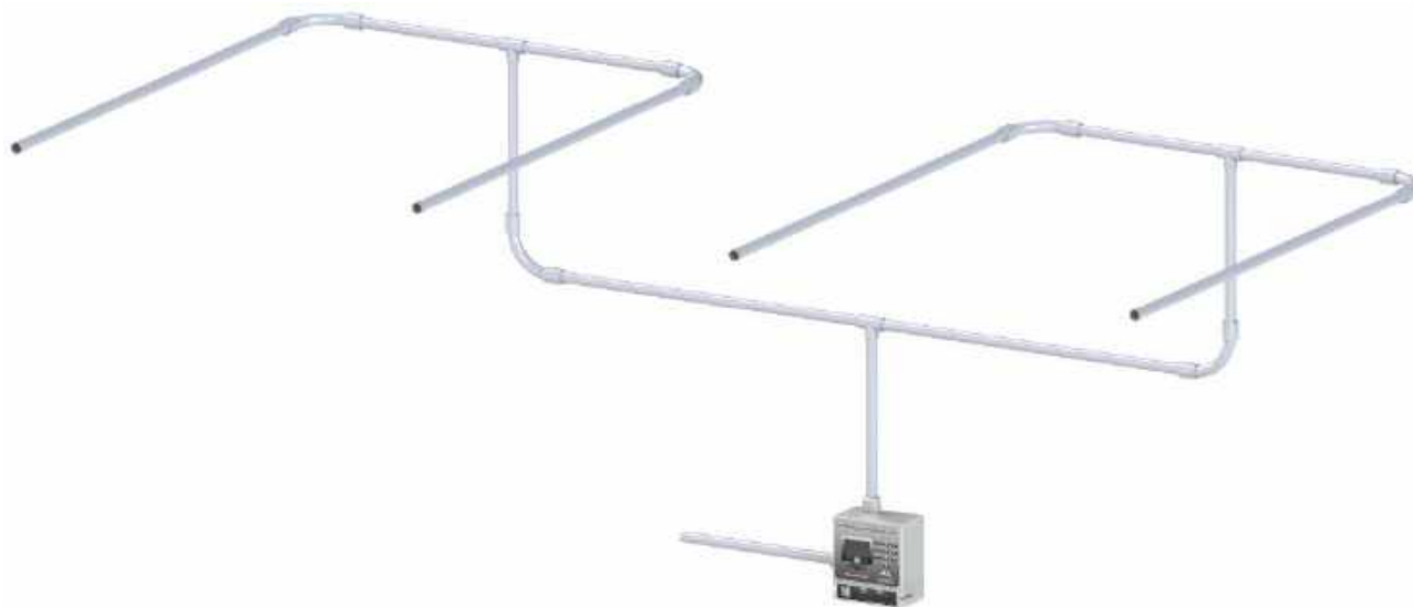
Рисунок 5 – Воздухозаборный трубопровод с 4 симметричными ветвями
