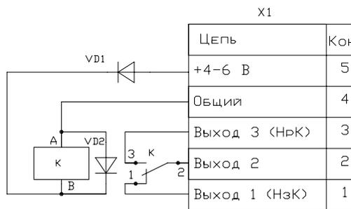
**Модуль сопряжения МС-1 v4.2 «УСПАА-1 v2»**
