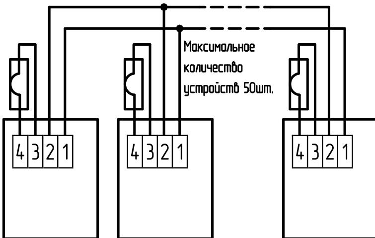
**Устройство сигнально-пусковое автономное автоматическое для установок пожаротушения УСПАА-1** соответствует требованиям ТУ 26.30.50-032-00226827-2017.
